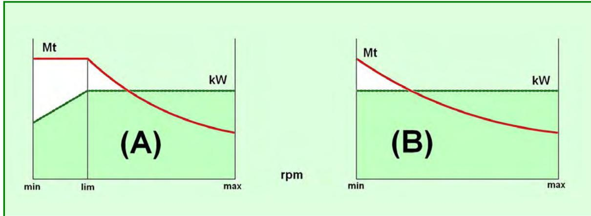
È consigliabile la selezione della velocità max del variatore coincidente con lo velocità max della macchina.
